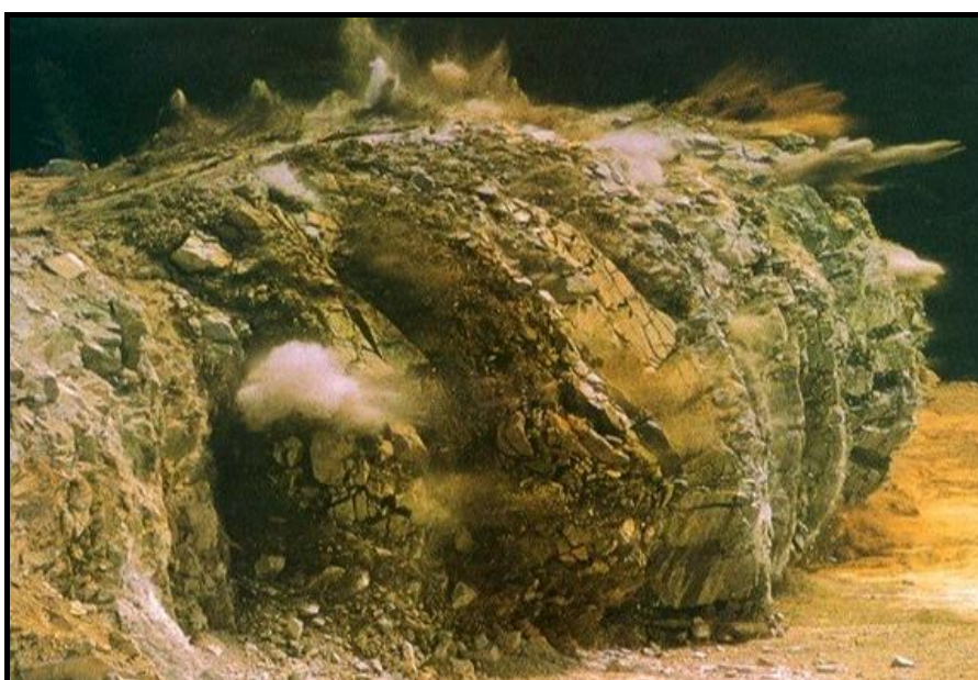
Figura 7 - Detalhe de uma detonação - fonte internet acessado em 05/12/2016.
